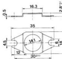
Fig. 14 Längsflansch
